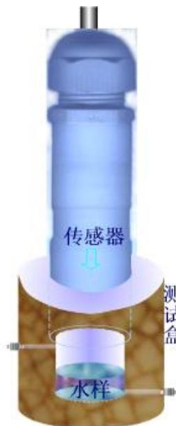
取水样 50 mL 左右, 置于样品盒中, 大约到容积 2/3 即可。将传感器插入等待 3-5 分钟, 系统会自动提示测试完成, 并显示结果。
